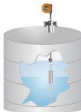
典型应用八：储罐液位测量
