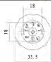
二线制4~20mA输出的变送器电气连接
