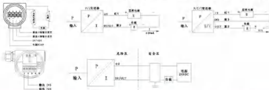
YC-3151-23型电气连接图 二线制4~20mA输出的变送器电气连接 三线制0/1~5V, 0~10/20输出的变送器电气连接
